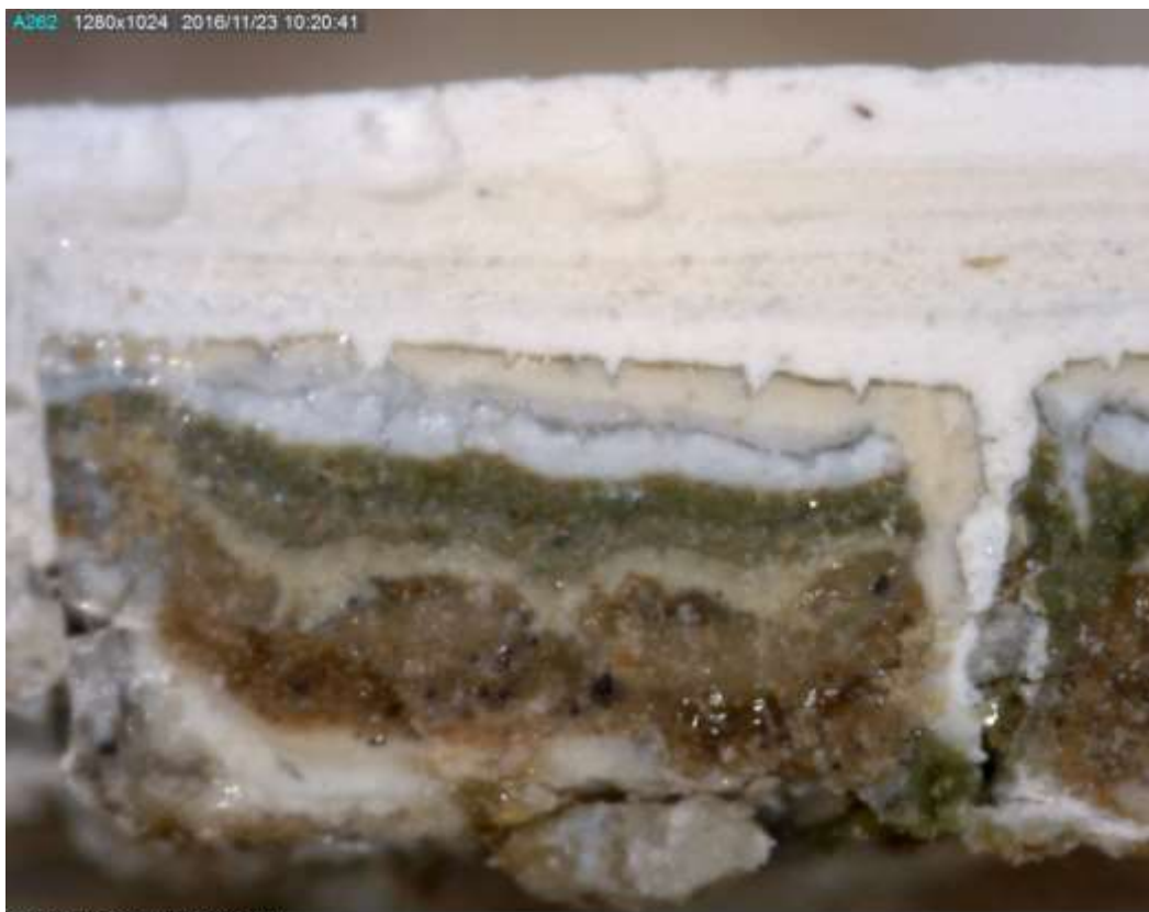
Figur 46. Skudeneshavn. Søragadå 26. Fargesnitt av malinglagene på laftekassene. De nederste malinglagene på denne prøven er ikke fullstendige, noen malinglag mangler. Foto: J. Brønne. November 2016.
