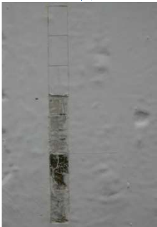
Figur 45. Skudeneshavn. Søragedå 26. Forsøk på fargelagsavdekking på laftekasse. Malinglagene var så avskrapet og omrotet at det ikke var mulig å utføre undersøkelsene ved å lage stratigrafiske fargelagsavdekkinger. Undersøkelsene av laftekassene er utført ved hjelp av feltmikroskop. Foto: J. Brønne. September 2016.
