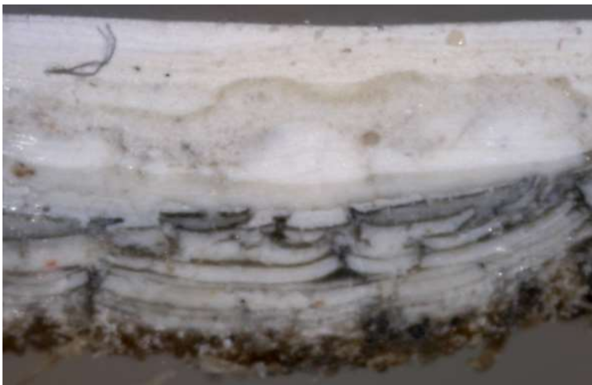
Figur 73. Skudeneshavn. Holmen 5. Fargesnitt av malinglagene på vinduene. Det er kun hvite malinglag. En del av de eldste, blyholdige malinglagene har vært meget skitne. Treverket er synlig nederst. Foto: J. Brønne. November 2016.
