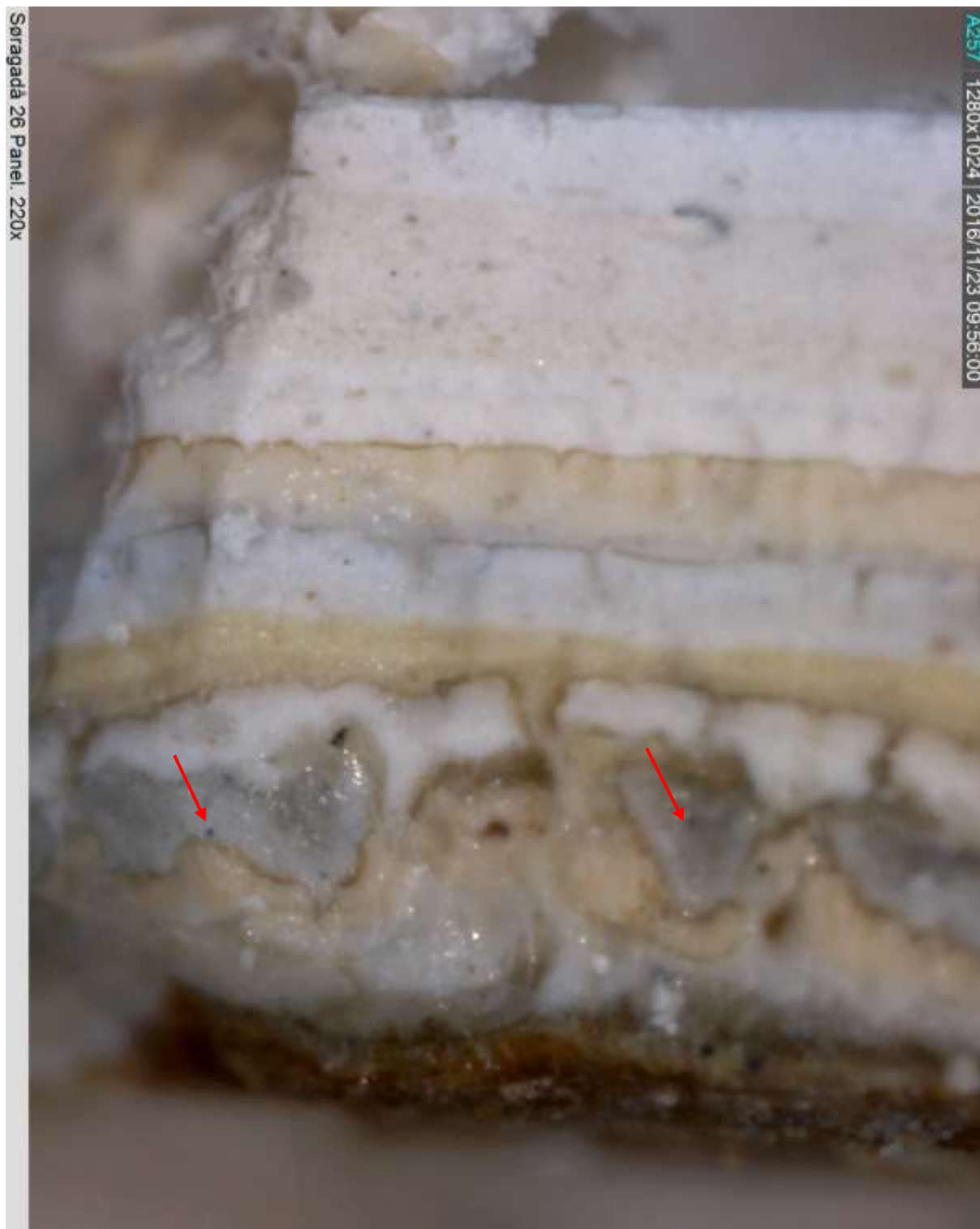
Figur 41. Skudeneshavn. Sørsgada 26. Fargesnitt av malinglagene på panelet. Nederst er treverket. De malinglagene som fremstår som lys gule er misfarging av den hvite malingen på grunn av stort innhold av linolje. Det er tre malinglag som er basert på blyhvit pigment og som har oksidert og blitt grått. Malinglag 3 er brukket med blå og sorte pigmenter. Det betyr at dette laget opprinnelig har vært lys grått. Rød pil. Alle de øvrige malinglagene på panelet har opprinnelig vært hvite. Foto: J. Brønne. November 2016.
