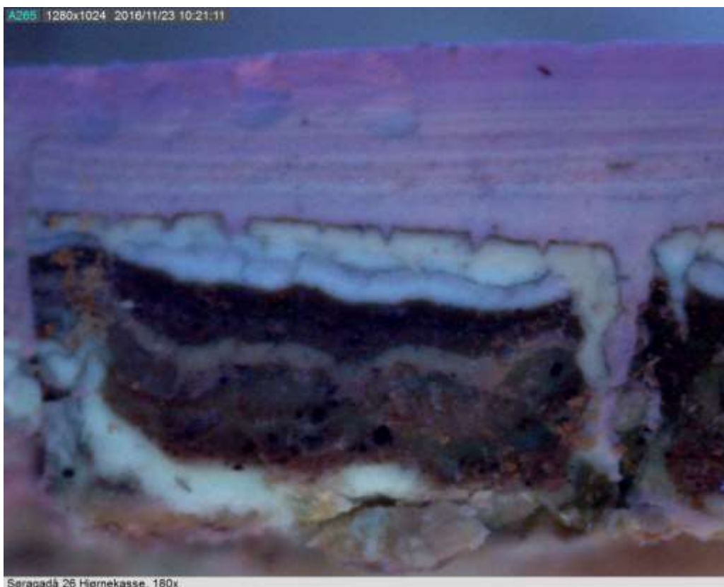
Figur 47. Skudeneshavn. Søragadå 26. Fargelagsavdekking av malinglagene på laftekassene fotografert i UV lys. De nederste malinglagene er tydelig omrotet, det sees av at det ikke er mulig å skille lagene tydelig fra hverandre. Foto: J. Brønne. November 2016.
