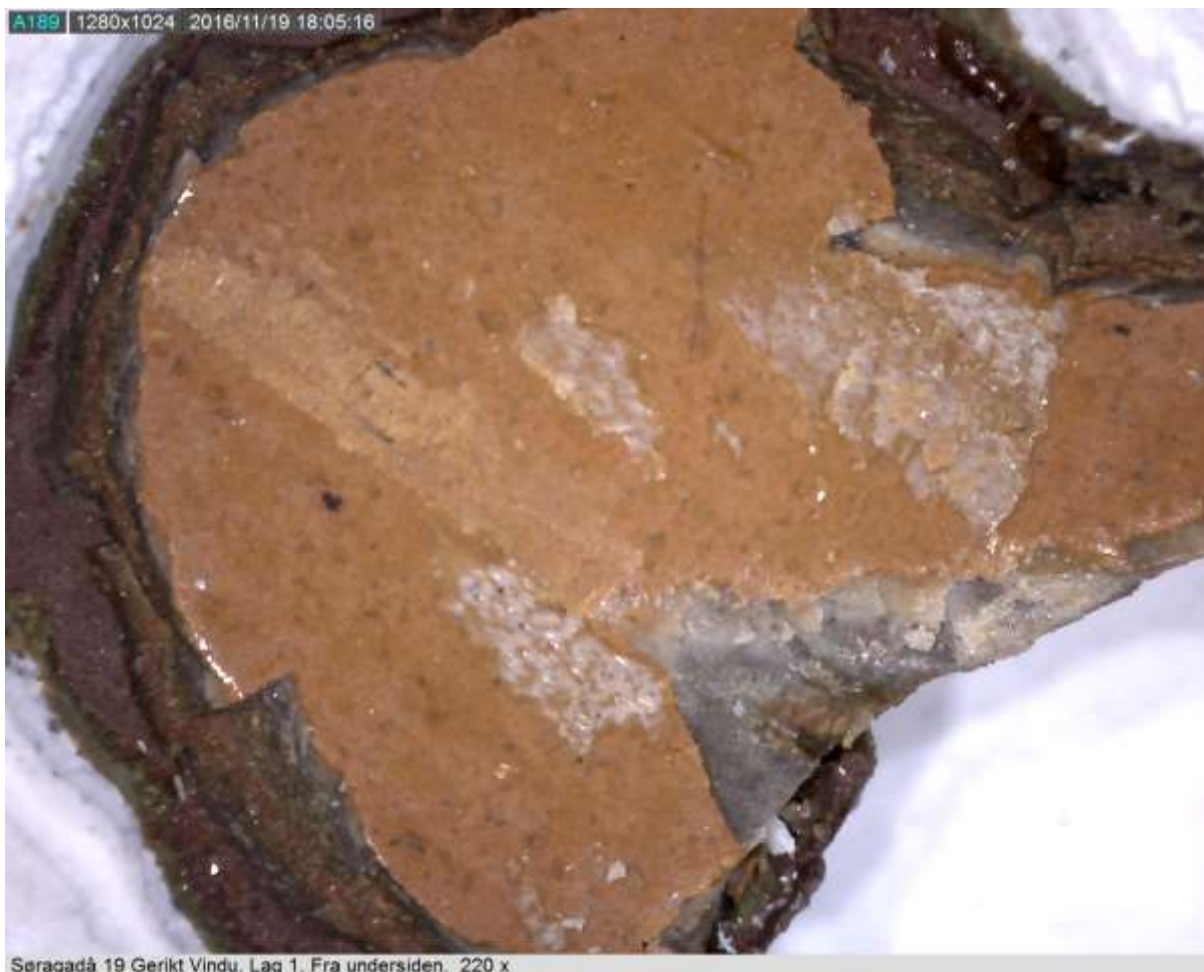
Figur 33. Skudeneshavn. Søragadå 19. Malingprøve fra vindusgerikten sett fra undersiden, dvs. det eldste malinglaget, gul oker. Foto: J. Brønne. November 2016.
