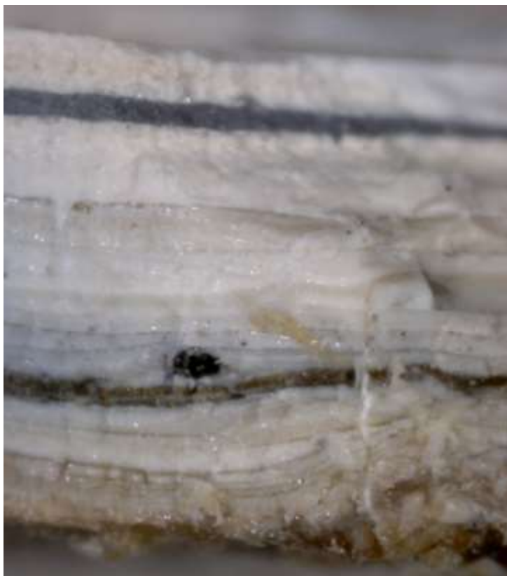
Figur 94. Skudeneshavn. Holmen 16. Fargesnitt av malinglagene på vindu. Det nest øverste, gråblå malinglaget er på grunn av skraping ikke med på fargelagsavdekkingen på figur 94. Foto: J. Brønne. November 2016.
