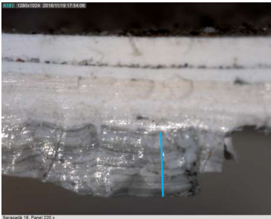
Figur 17. Skudeneshavn. Søragadå 18. Fargesnitt av malinglagene på panelet. På fargesnittet er alle malinglagene, inklusive grunningsstrøk, mellomstrøkene og sluttstrøkene. De nederste malinglagene er grå, her markert med en blå strek. Selv med forstørrelse opp mot 400X er det ikke mulig å se pigmentkorn i de grå malinglagene. Det betyr at de malinglagene som i dag fremstår som grå, opprinnelig var hvite, med blyhvit som pigment. Blyhvit oksiderer i luft, og blir grå. Oksidasjonen forsterkes hvis det er forurensing i luften, for eksempel fra svovel. Svovelforurensing kan komme fra fyring med koks, sinders, kull og torv. Det er tynne lag med skitt og smuss på overflaten av de fleste lagene med blyhvit. Forurensingen er imidlertid vesentlig mindre enn det vi finner på huset rett over gata, Søragadå 19. Undertegnede har ingen forklaring på dette. Foto: J. Brønne. November 2016.
