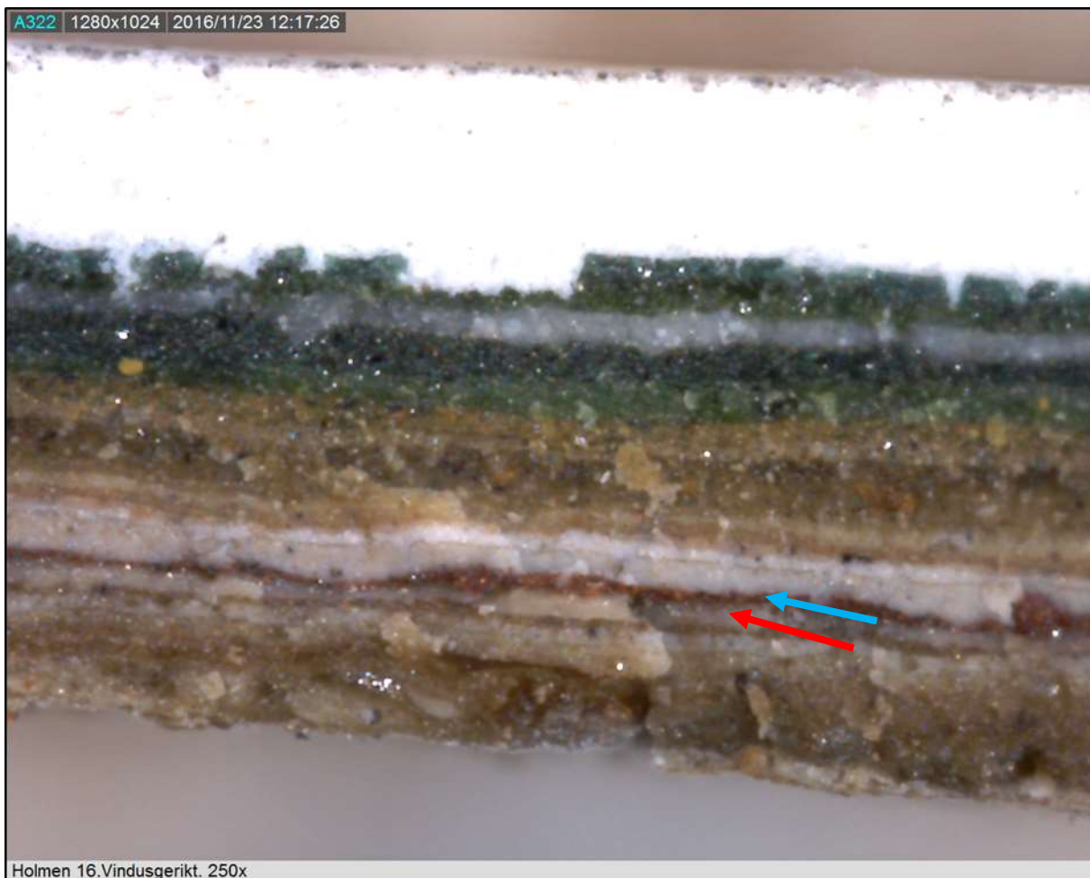
Figur 96. Skudeneshavn. Holmen 16. fargesnitt av malinglagene på vindusgeriktene. Lag L3 er en mahogniillusjon. Denne består av en undermaling og en lasur. På fargesnittet sees disse lagene som et normalt tykt lag, rød pil, og et tynt lasurlag, blå pil. På grunn av lyset i digitalmikroskopet er det ikke mulig å skjelle de nyeste hvite malinglagene fra hverandre. Foto: J. Brønne. November 2016.
