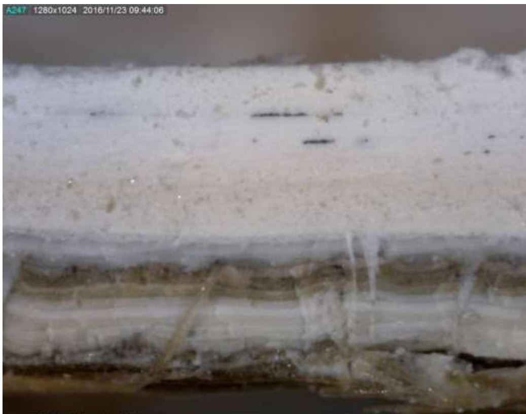
Figur 108. Skudeneshavn. Gunnarsbakken 5. Fargesnitt av malinglagene på laftekassene. Malinglagene sammenfaller med lagene på panelet. Foto: J. Brønne. November 2016.
