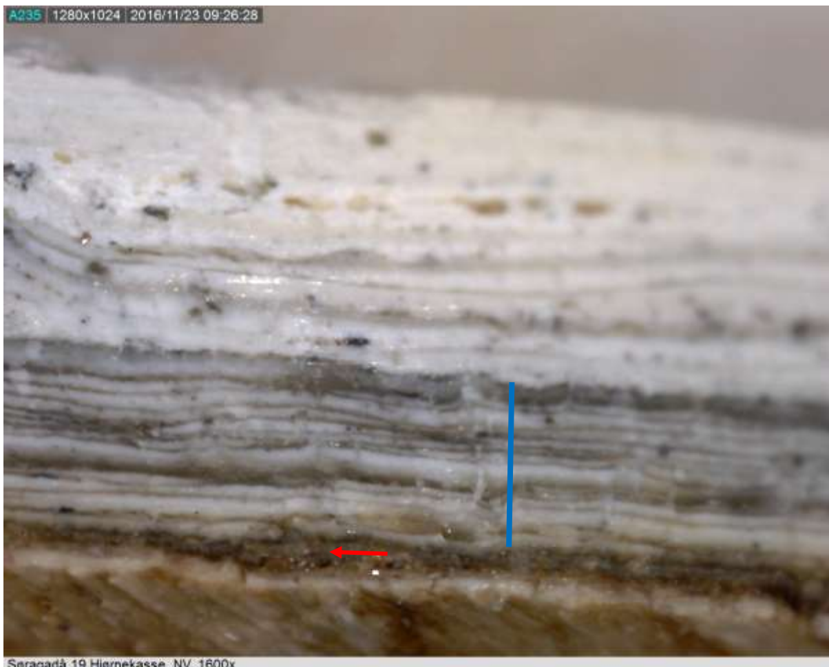
Figur 30. Skudeneshavn. Søragadå 19. Fargesnitt av malinglagene på laftekassene. Fargesnittet viser usedvanlig mange malinglag med hvit maling. Nesten alle lagene har et markert skittlag på overflaten. Dette gjelder både grunningsstrøkene, mellomstrøkene og sluttstrøkene. Dette tyder på en usedvanlig stor grad av forurensing i lufta. Dette kan både være forårsaket av sot fra fyring, og flyveforurensing av fin sand og jord. De malinglagene som består av blyhvit er markert med en blå strek. Opprinnelig malinglag, Lag L1 er markert med rød pil. Foto: J. Brønne. November 2016.
