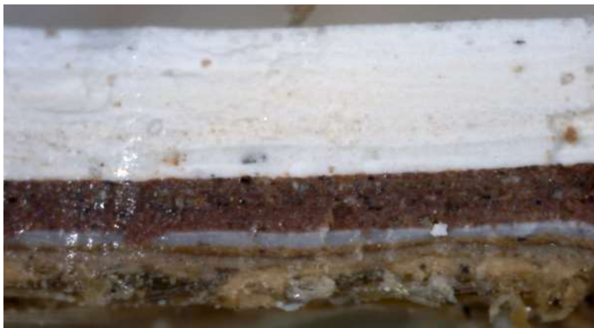
Figur 61. Skudeneshavn. Søragedå 37. Fargesnitt av malinglagene på laftekassene. Nederst sees trevirket. Foto: J. Brønne. November 2016.
